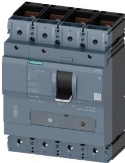
interruttore automatico 3VA1 IEC Frame 630 classe del potere di interruzione N Icu=36 kA con 415 V a 4 poli, protezione impianto TM240, ATAM, In=630 A protezione da sovraccarico Ir=441 A ... 630 A protezione da cortocircuito li=4 ... 8 x In protezione del conduttore di neutro 50 % attacchi piatti a vite
